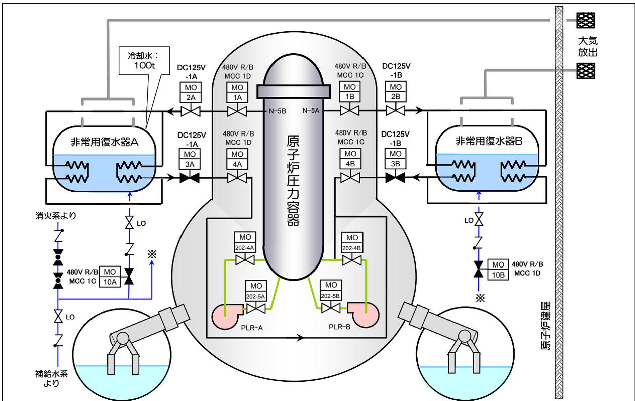
地震後(原子炉圧力高で自動起動)
