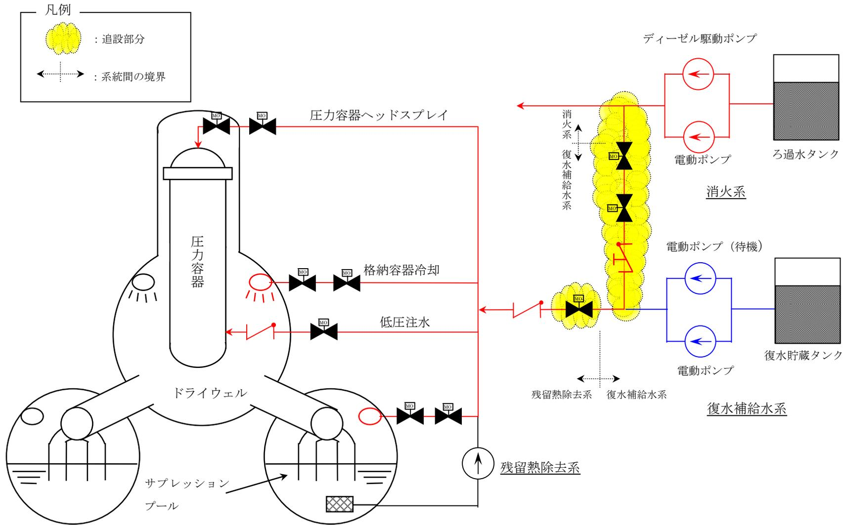
代替注水設備（2～5号炉，概念図）
