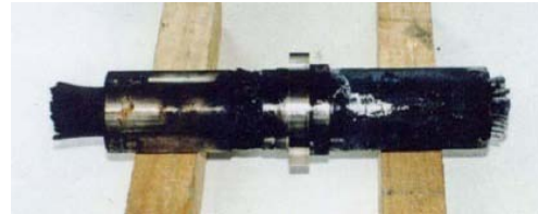
電線貫通部の過温劣化状況
