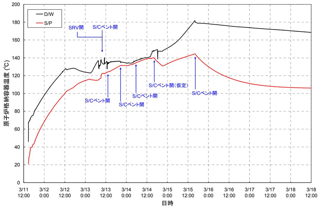
図 4-5 3号機 格納容器温度変化
