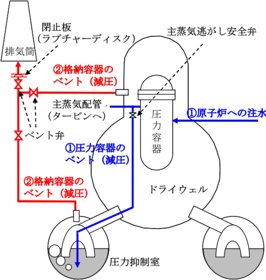
格納容器：ドライウェルと圧力抑制室をあわせた部分
