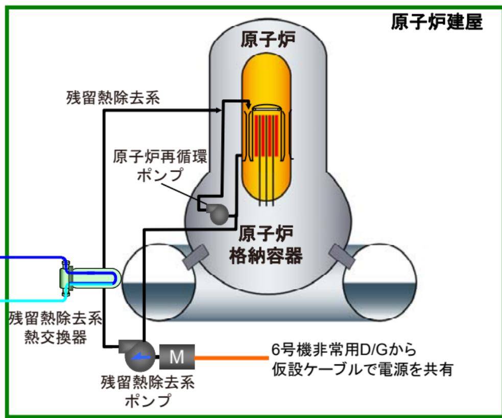
(注) 上記は残留熱の除去システムを模式的に記載したものであり、ポンプや熱交換器は複数系統設置されている
