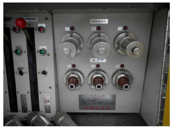
東北電力高压電源車。当社の高压電源車と同様に、P/C まで送電するためには仮設ケーブルの敷設及び端末処理が必要（後日撮影）
