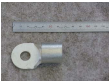
端末処理でケーブルに接続する端子。 3線×2(両端)の6箇所の接続が必要。
