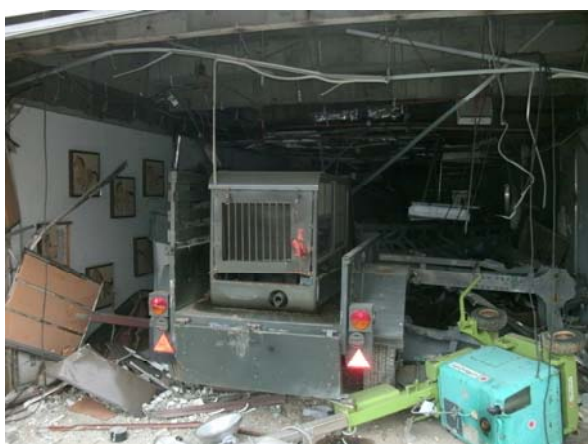
自衛隊低压電源車。トレーラーに小型発電機が積載されたもので、移動には牽引が必要（後日撮影）
