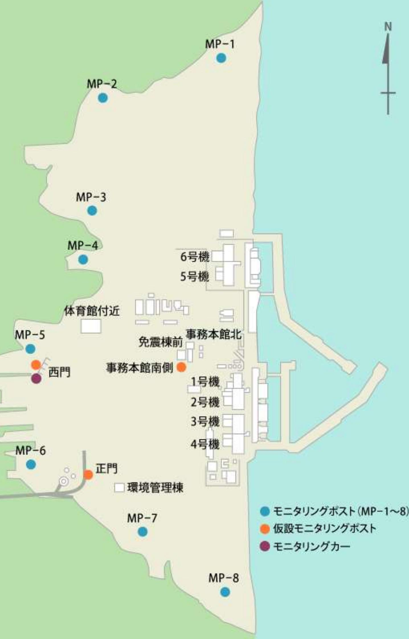
図2. 福島第一原子力発電所構内の空間線量率計測機 設置箇所
