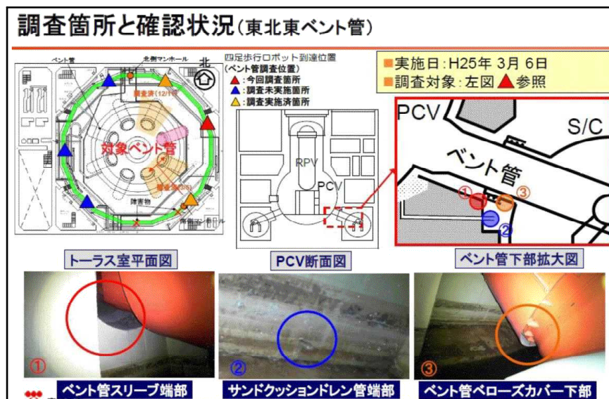
図6-2 ロボットによる2号機原子炉格納容器の調査結果
