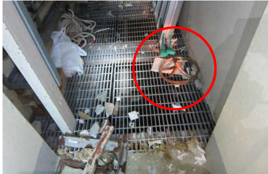
写真 1-8 原子炉建屋 4 階の破損したハンドル (南)
